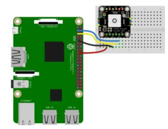
Pi 3V to module VIN Pi GND to module GND
